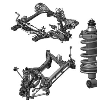
**SUSPENSIONES** - Las suspensiones han sido diseñadas en colaboración con Lotus para un uso mixto en carretera y fuera de carretera. Para optimizar el comportamiento de Mahindra XUV500 en estas superficies tan diferentes entre sí, los diseñadores han optado por una solución de ruedas independientes - delanteras tipo McPherson, traseras Multi-link - con muelles helicoidales y barras estabilizadoras.
