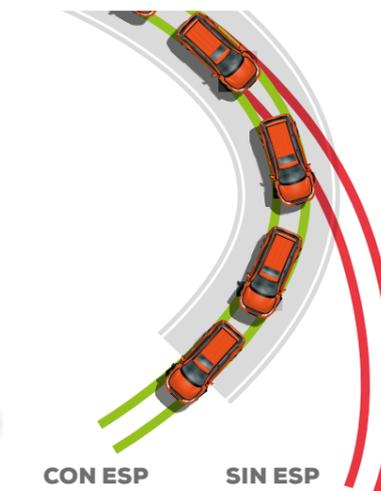
**ESP** - Es un sistema de gestión electrónica que controla constantemente los movimientos y la dirección del vehículo y, cuando detecta una pérdida de control, actúa sobre los frenos y el motor hasta restablecer la estabilidad.
