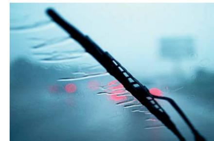
**SENSORES DE LLUVIA** - Sensores avanzados que detectan la lluvia y encienden o apagan automáticamente los limpiaparabrisas. El sistema también controla la velocidad de las escobillas de acuerdo con la intensidad de la lluvia.
