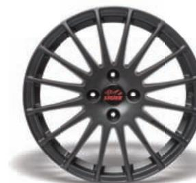
Llantas de aleación de aluminio de 16". Diseño de 16 multirradios en negro mate.
