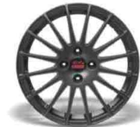
Llantas de aleación de aluminio de 16". Diseño de 16 multirradios en negro mate.
